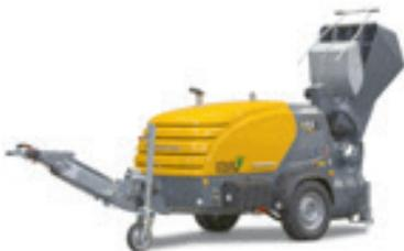
**Estrichpumpe PUTZMEISTER MIXOKRET M760 DHBS STAGE V GREEN EFFICIENCY Beschicker + Schrapper**
