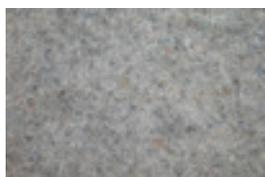
**Geotextil-Vlies PROFLEX® COLOR RPES AG 200 g/m<sup>2</sup>**
