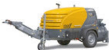
**Estrichpumpe PUTZMEISTER MIXOKRET M740 DH STAGE V
