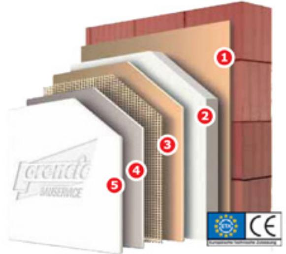
Das klassische, kostengünstige Wärmedämmverbundsystem mit LORENCIC Klebespachtel (Armierungsschichtdicke 3 mm), herkömmlichen EPS-F Fassadendämmplatten 040 oder hochwärmedämmenden grauen EPS-F Fassadendämmplatten 031.
