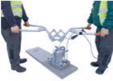
**Vakuu-Hand-Verlegegerät SPEEDY VS-140/200 PROBST**
