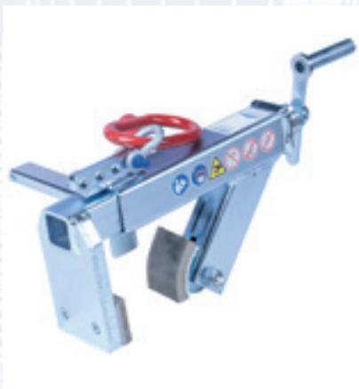
Immer häufiger werden Granitstelen im Galabau eingesetzt. Dafür wurde speziell der handliche Stelensetzer SLS-8/20-G-VA entwickelt. Der an einem Hebegerät, z.B. Mini-Bagger, angehängte SLS wird über eine Handkurbel an eine liegende Stele angesetzt. Beim Anheben tritt eine automatisch wirkende Spannkrafterhöhung ein und die Stele lässt sich sicher aufrichten und versetzen. Nach dem Versetzvorgang wird die Handkurbel wieder gelöst.
