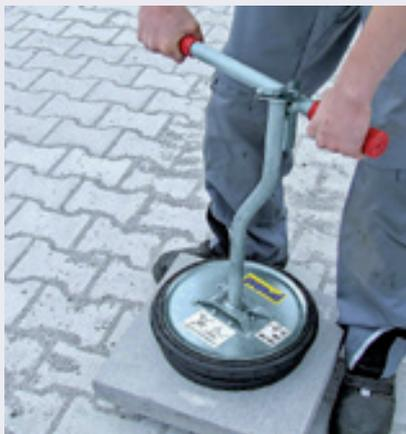
Ein-Mann-Gerät für leichte Steinplatten und kurze Transportwege.
