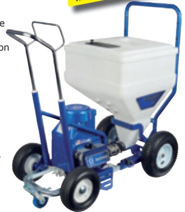
Im Lieferumfang enthalten: Spritzpistole T-MAX mit RAC X Düsenhalter und Düsen HDA651 + HDA655, Schlauch 1" x 10 m, Schlauchpeitsche 3/4" x 3 m, Werkzeugbox, Schaber für Reinigung.
