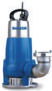
Multifunktionale Tauchmotorpumpe mit Edelstahl-Motor und Hydraulik aus GG (Grauguss). Vortex- Hydraulik für verschleißarmes Pumpen von leicht verschmutzten und abrasiven Medien.
