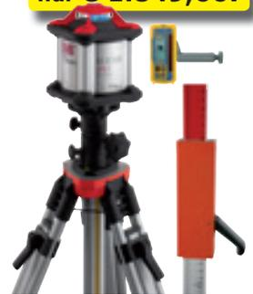
Im Lieferumfang enthalten: Rotationslaser BMI NAUTILUS IPX7, Empfänger + Halterung HL450 (mit mm-Anzeige), Ladegerät in Tragetasche, Kurbelstativ, Laserlatte mit Gleitadapter in Transporthülle.
