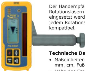
Der Handempfänger HL450 kann mit den Rotationslasern SPECTRA HV 301 und HV 302 eingesetzt werden, ist jedoch grundsätzlich mit jedem Rotationslaser mit rotem Laserstrahl kompatibel.
